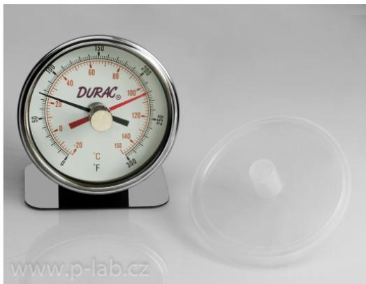
Teploměr maximální bimetalový
